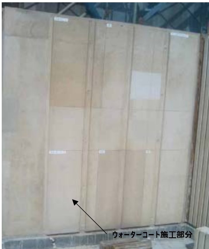
各社施工後 5 銘柄による性能比較対照試験パネル
