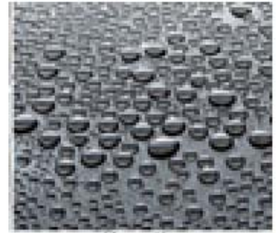
施工後の撥水系ポリマーコート
